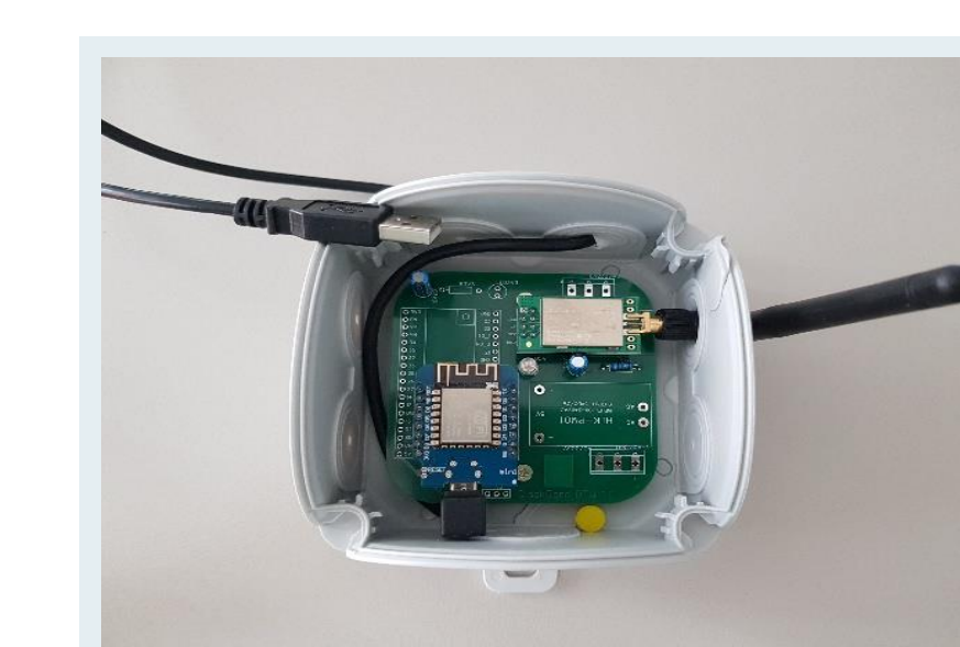
Abb. 17: Kommunikationsplattform bestehend aus WLAN-Modul und 2,4-GHz-Funkmodul
