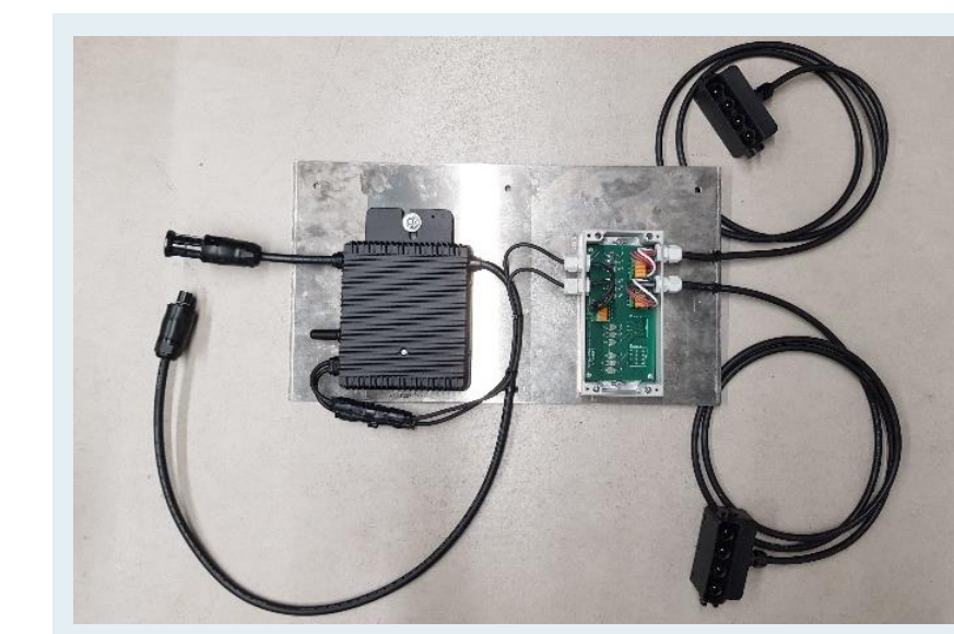
Abb. 15: Basis-Trägerplatte (2er-Einheit) mit Modulwechselrichter und Junctionbox
