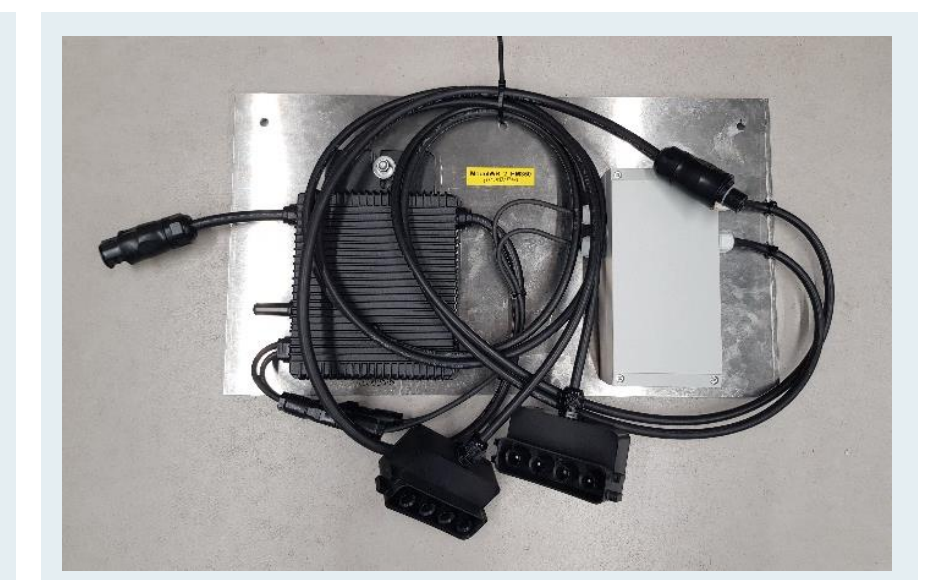
Abb. 16: Komplett vormontierte virtuelle 2er-Einheit
