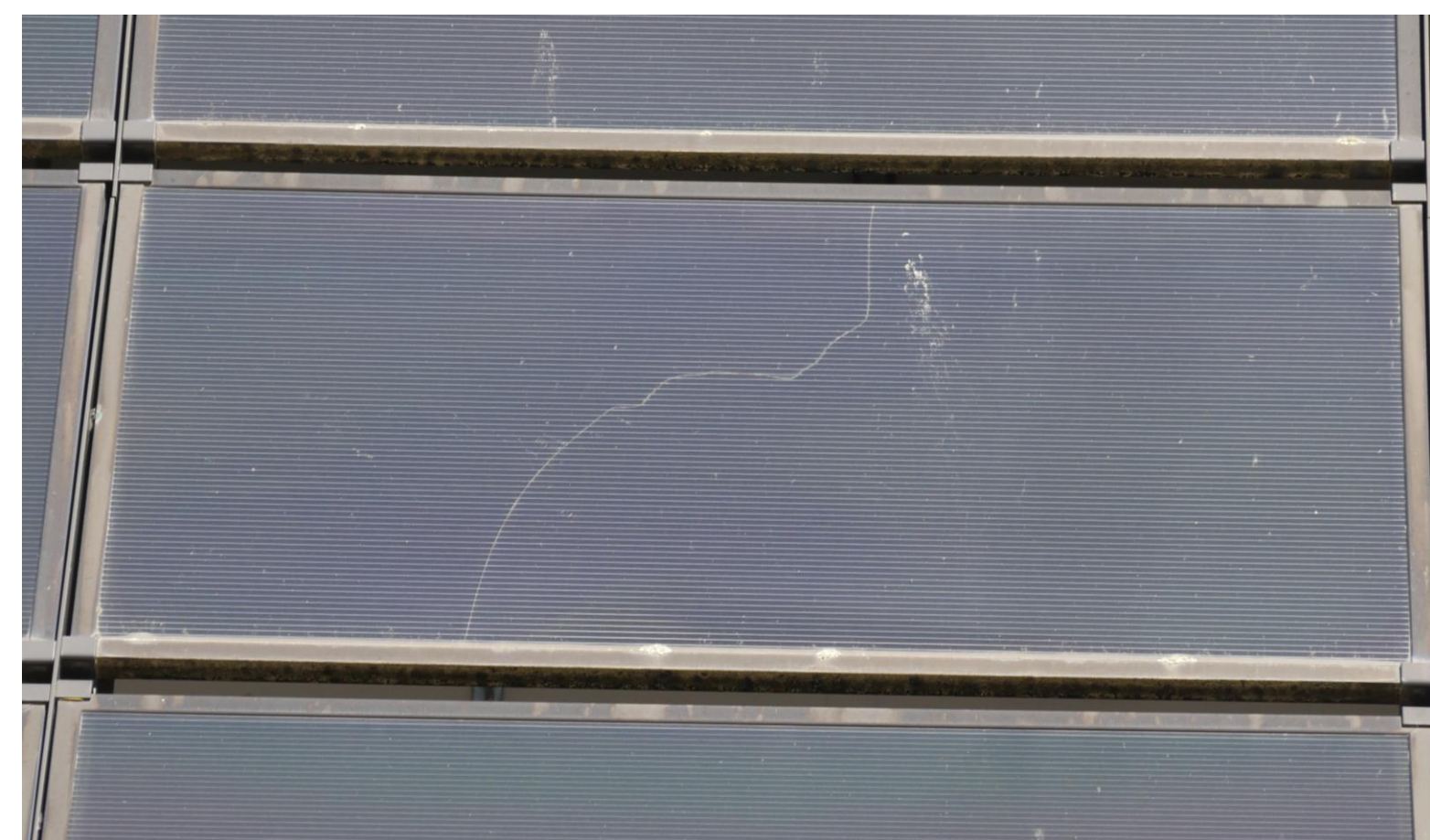
Ferdinand Braun Institut Berlin; Modulbruch an gerahmten CIS-Modulen, wahrscheinlich eine Kombination von Thermischem und Mechanischem Bruch
